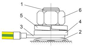
• Tightening torque: 4 Nm
