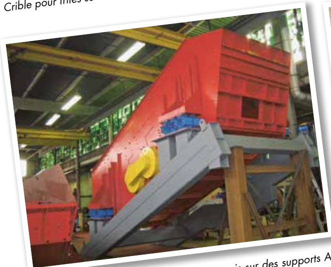
Crible pour frites sur des supports AB (acier inox).
