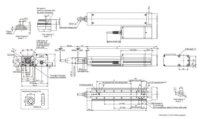
M.E. : Mechanical End S.E. : Stroke End
