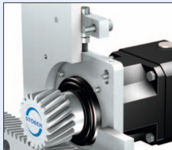
Einstellplatte (Einstellweg > Zahnhöhe) für P und PE Getriebe mit optionaler Justiereinrichtung, Ritzel in Anbauposition E
