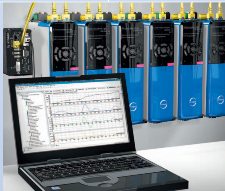
Zentrale Inbetriebnahme einer CODESYS Multiachs-Anwendung.
