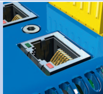
Schnittstelle für den Integrated Bus IGB.
